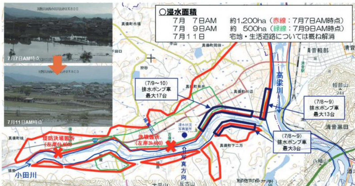
浸水状況と排水ポンプ車稼働状況
