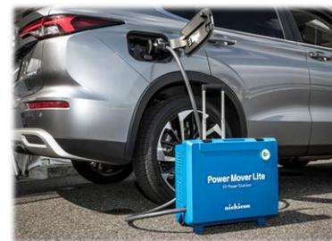
三菱製PHEV等の電動車両による電源供給
